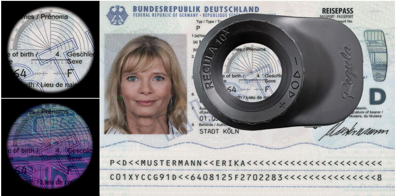
Regula 1004MU პასპორტის გვერდზე - LED სინათლის წყაროები: ირიბი თეთრი, ულტრაიისფერი 365 ნმ - 10x გადიდება
