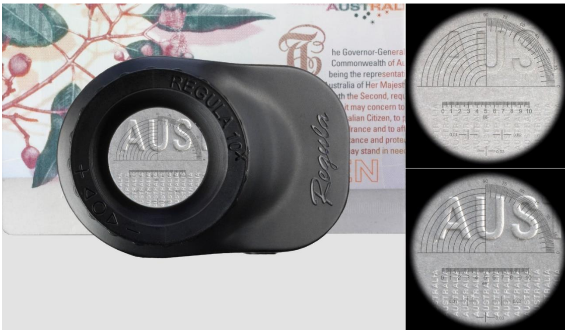
Regula 1004M პასპორტის გვერდზე - LED განათების წყაროები: დამცემი - თეთრი, ირიბი თეთრი - გადიდება 10x
